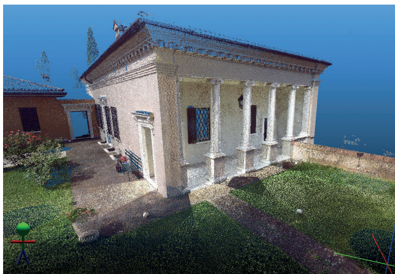
Fig. 1 – Modello a nuvola di punti colorato da laser scanner del portico nord del casino Avogadro
