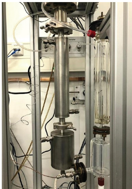
Figura 4 – Sistema a permeazione del VSL basato su una bilancia a sospensione magnetica
