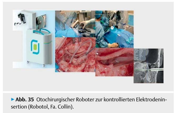
► **Abb. 35** Otochirurgischer Roboter zur kontrollierten Elektrodeninsertion (Robotol, Fa. Collin).
