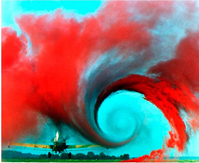
Figura 1.28: Utilitzant tints o fum acolorit podem visualitzar la trajectòria d'un fluid que passa per una regió. [Font: Langley Research Center (NASA)]
