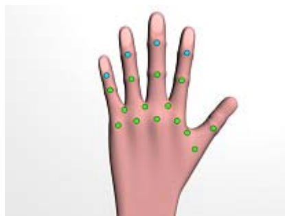
Figura 4. Posición de los sensores en los guantes de datos.
