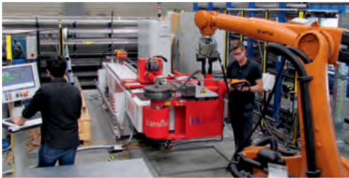
Einrichtung der neuen teleoperativen Biegezelle
