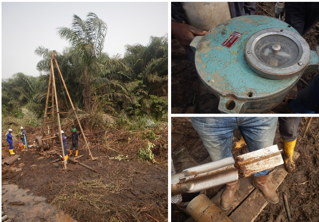
Bild 8 Im Rahmen der Nacherkundung ausgeführte Flügelsondierungen
