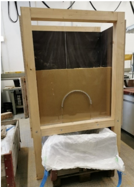
Bild 5 Fertig befüllter Versuchsstand und Versagen beim Modellversuch durch Öffnen der Klappe an der Unterseite des Versuchsstandes
