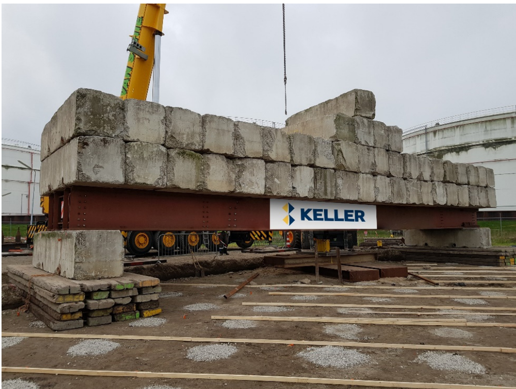
Bild 5 Statische Probelastung an Hybridsäulen (CMM ® )
