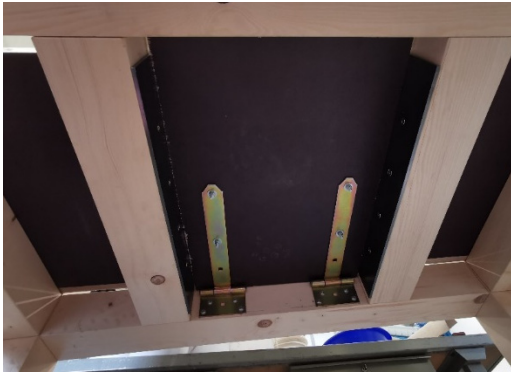
Bild 3 Klappenmechanismus an der Unterseite der Versuchsbox (links) und Anschlagmittel für Kran an der Versuchsbox (rechts)
