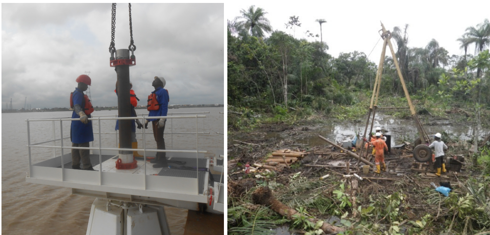
Bild 3 Drucksondierung im Fluss (links); Bohrung im Sumpf (rechts)
