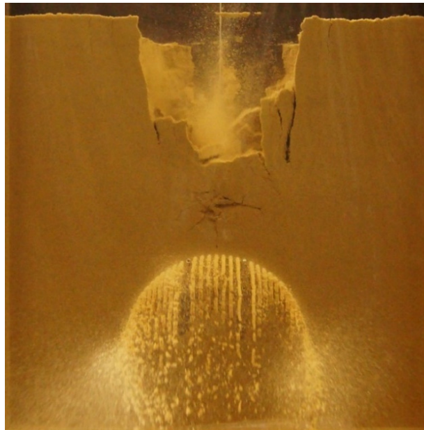
Bild 5 Fertig befüllter Versuchsstand und Versagen beim Modellversuch durch Öffnen der Klappe an der Unterseite des Versuchsstandes
