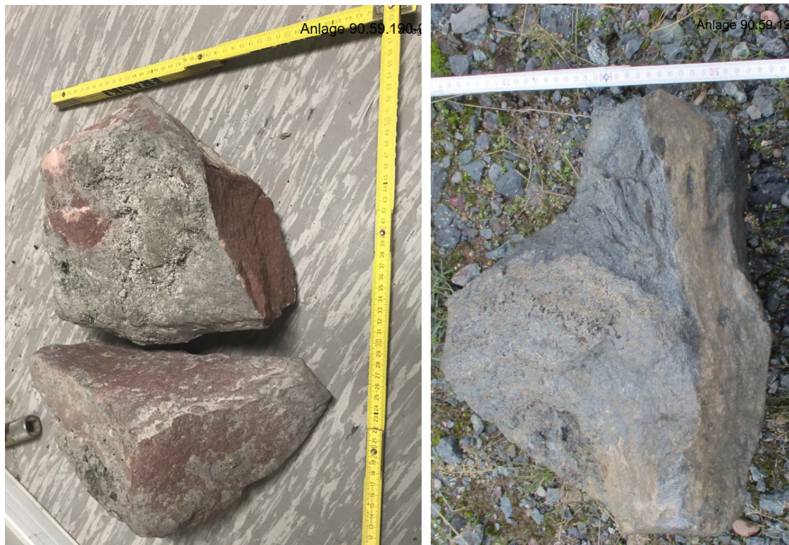
Bild 8 Mittels Bohrungen geborgene geologische Schlitzhindernisse
