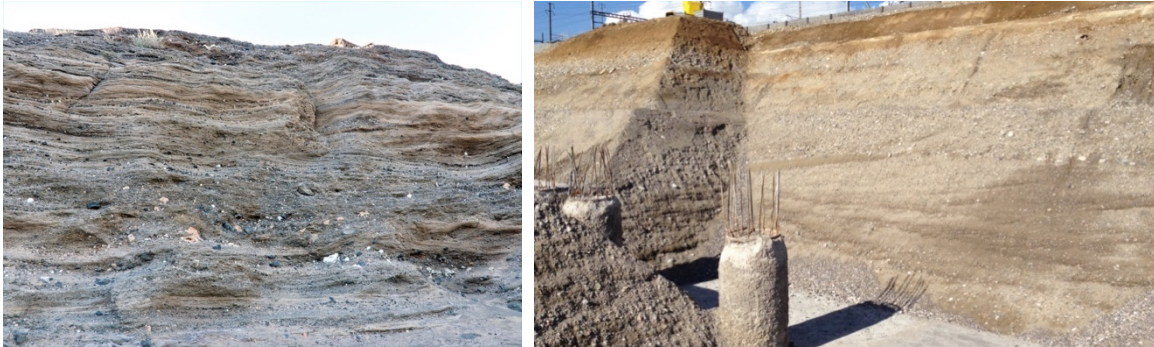
Bild 4 Beispiele für die Baugrundsichtung rolliger Böden (Bild links san-photo.heraut.eu, Bild rechts U. Trunk)
