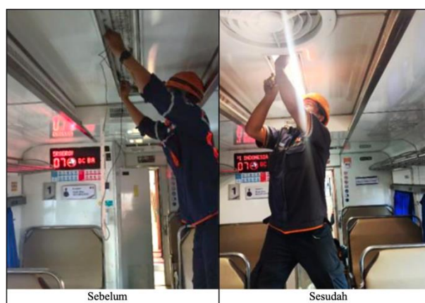
Gambar 3. Sampel temuan fisik ketidaksesuaian layanan KA PSO antarkota terhadap SPM dan tindak lanjut periode Triwulan I (penggantian lampu penerangan pada KA Cikuray)
