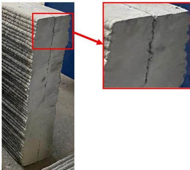
**Рис. 7.** Зона нарушения сплошности бетона, приуроченная к зоне контакта рядов при многорядной технологии изготовления конструкции
