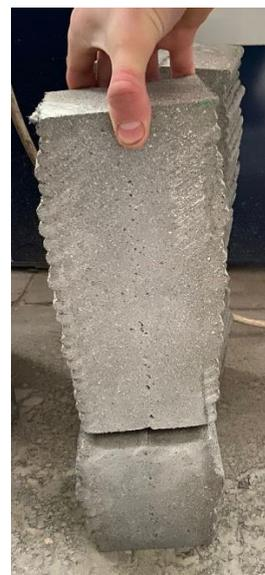
**Рис. 8.** Разрушение образца, выполненного по двухрядной технологии 3D-печати, по линии контакта слоев
