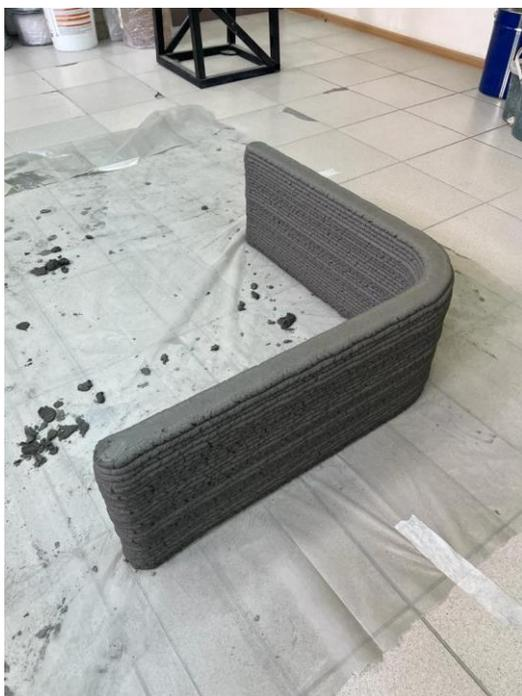
**Рис. 2.** Фрагмент конструкции, выполненный по технологии 3D-печати бетоном с однорядным проходом печатающей головки
