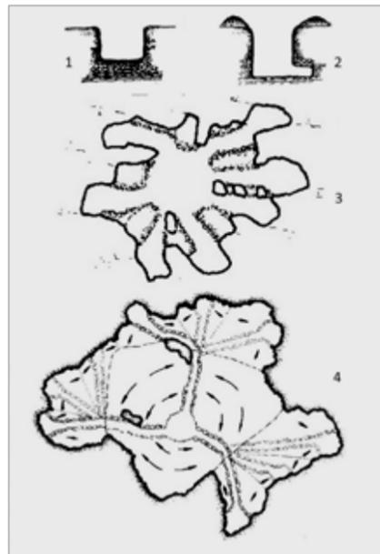
Fig. 11. Tipos principales de trabajos de explotación en la mina de Krzemionki (Polonia): 1) pozo, 2) galería-nicho, 3) mina de pilares, 4) cámara. Fuente: composición a partir de Migal (1997).
