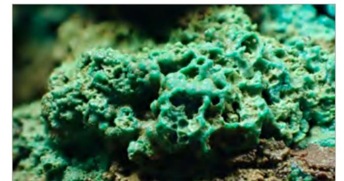
las liditas blanquecinas [Figs. 28 y 29]. Al microscopio de luz transmitida se presenta muy poco cristalina, con colores de interferencia de primer orden. El color azulado anómalo del mineral es debido a la presencia de pequeñas cantidades de Cu, posiblemente en la posición estructural del Ca.
