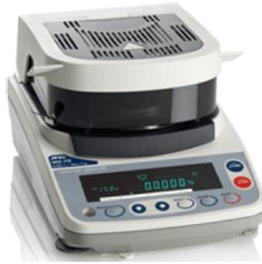
Fuente: Microlab Industrial (2018). *Método de la termobalanza.*
