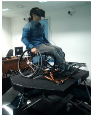
**Figura 3.12:** Plataforma de movimiento, sistema háptico y silla de una interfaz. *Fuente:* [13]
