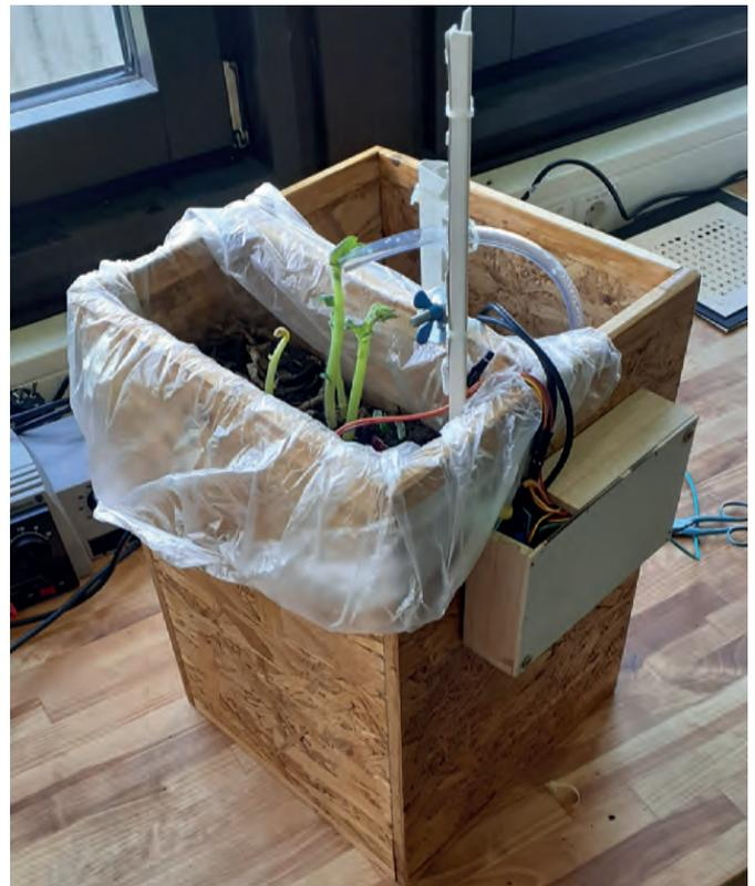
Abbildung 4: Blumentopf mit integrierter Elektronik
