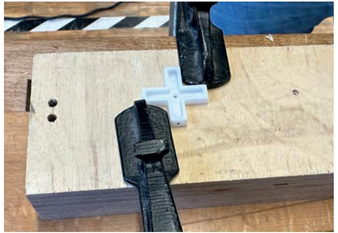
Abbildung 42: Fugenkreuz für mittige Bohrung einspannen
