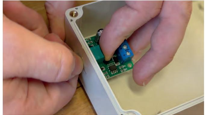
Abbildung 33: Einsetzen des Drehzahlreglers
