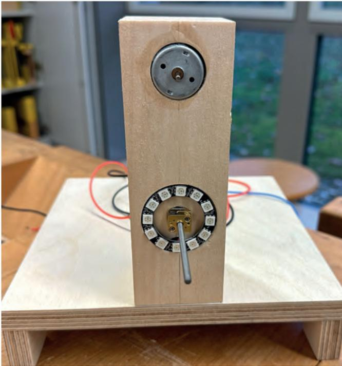
Abbildung 27: Gehäuse mit Motoren und LED-Ring
