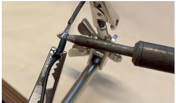
Abbildung 29: Verlöten der Jumper-Kabel mit den SD
