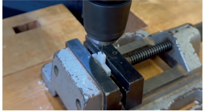
Abbildung 41: Fugenkreuz bohren
