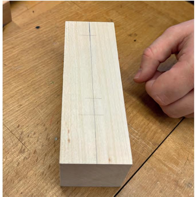
Abbildung 6: Rückseite Motorengehäuse anzeichnen
