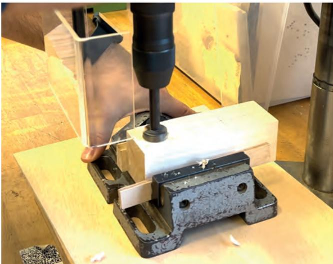
Abbildung 8: Bohren der Vorderseite
