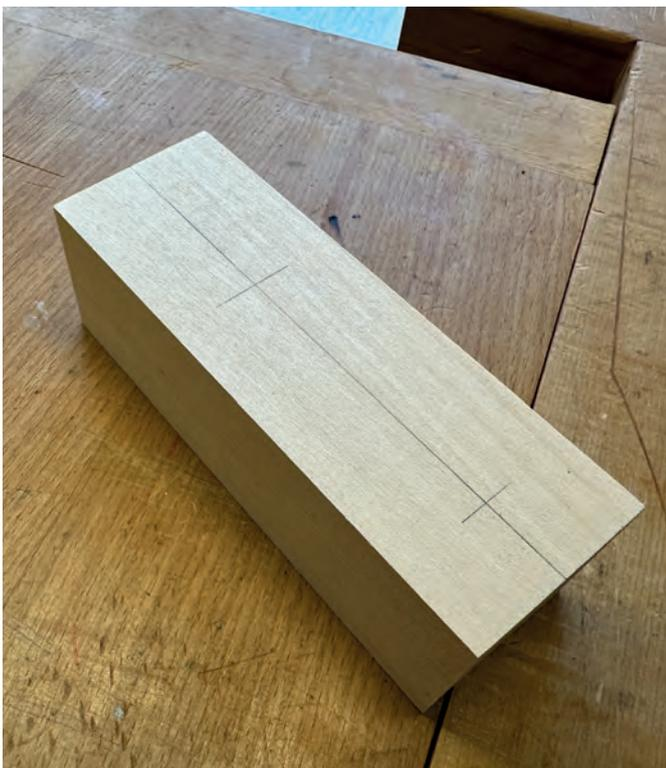
Abbildung 5: Vorderseite Motorengehäuse anzeichnen
