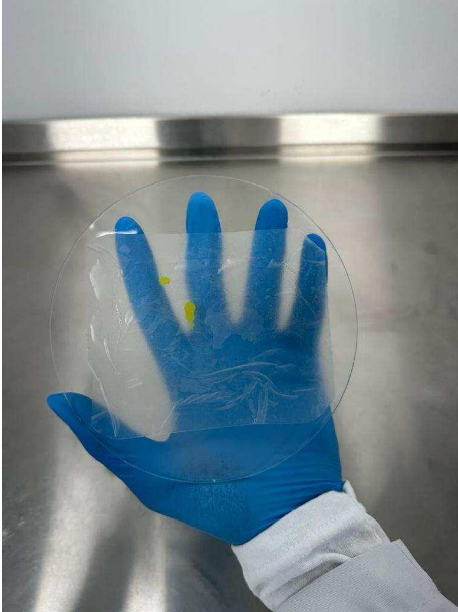
Figura 4 - Aderência do curativo adesivo hidrocolóide a superfície irregular do vidro de relógio
