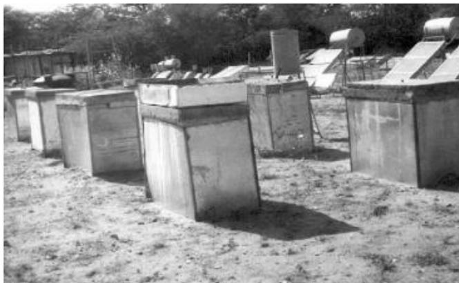
**Figure 3.5 :** Les différentes cellules tests construit à Jodhpur, Inde. (Source : (Nahar *et al.*, 2003))
