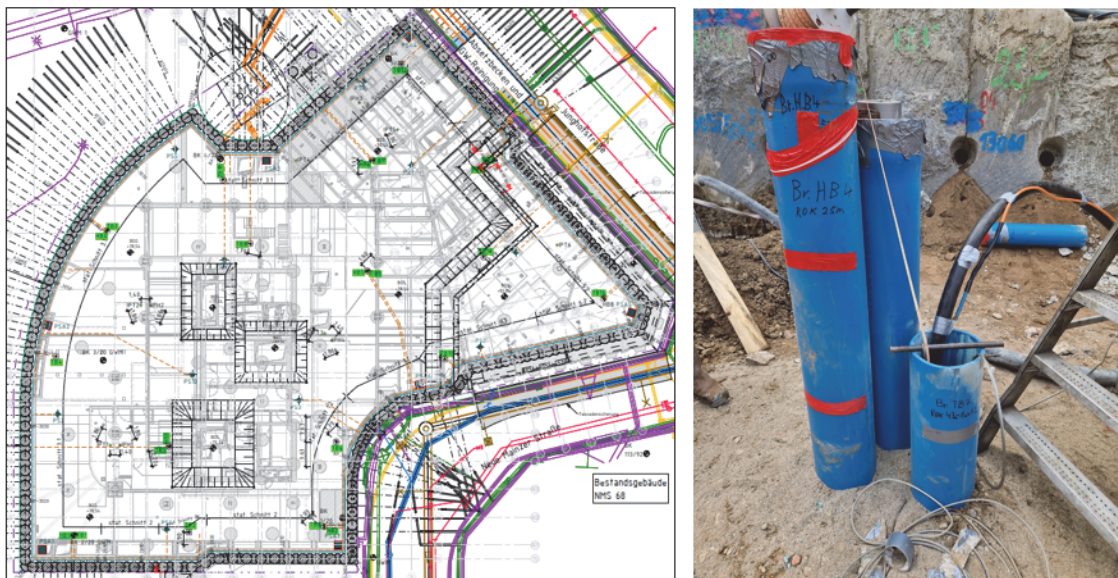
Bild 11 Links: Wasserhaltungsplan (Quelle: Züblin Zentrale Technik) Rechts: Kopf vom Doppelstockbrunnen mit Kontrollbrunnen beim CBT
