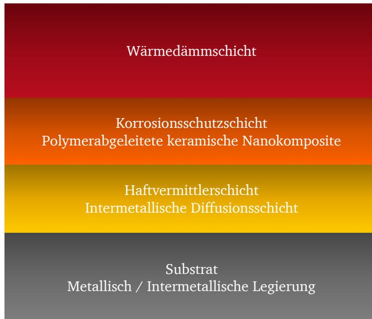
Abbildung 43: Schematische Darstellung einer möglichen Weiterentwicklung des konzeptuellen Materialsystems des Graduiertenkollegs MatCom-ComMat RTG 2561.
