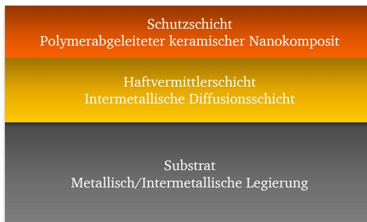
Abbildung 1: Schematische Darstellung des konzeptuellen Materialsystems des Graduiertenkollegs MatCom-ComMat RTG 2561.
