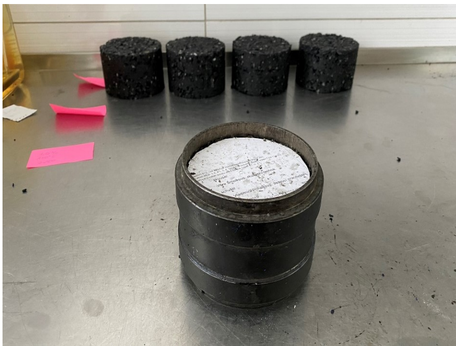
Obrázek 16 – Marshallové těleso před vytlačáním z hutnicí formy
