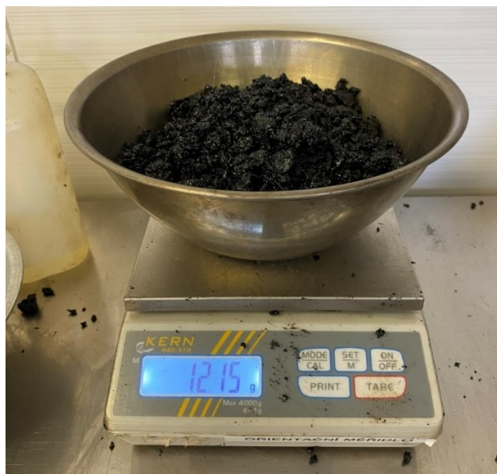
Obrázek 15 – navážka asfaltové směsi pro výrobu Marshallových těles
