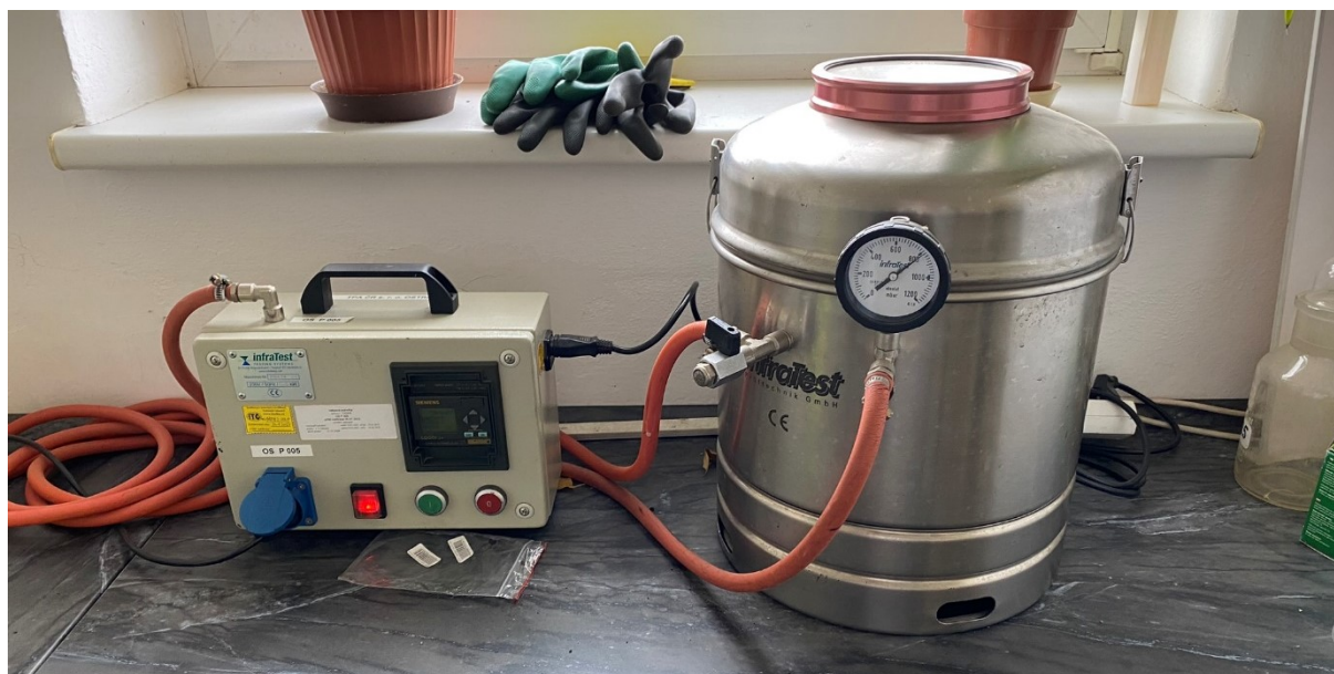
Obrázek 9 – nádoba s kalibrovaným vakuometrem
