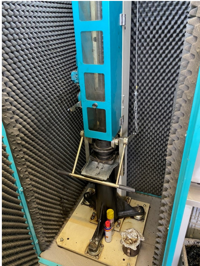
Obrázek 8 – rázový zhutňovač Marshallových těles
