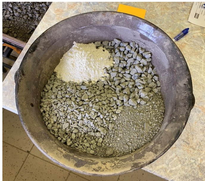
Obrázek 12 – zvážená navážka kameniva pro výrobu asfaltové směsi ACO 11+ 50/70
