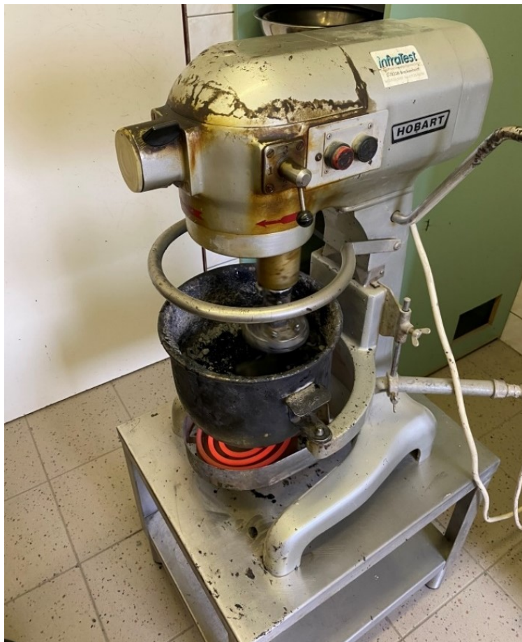
Obrázek 13 – zahřívání míchací nádoba na mísení asfaltové směsi
