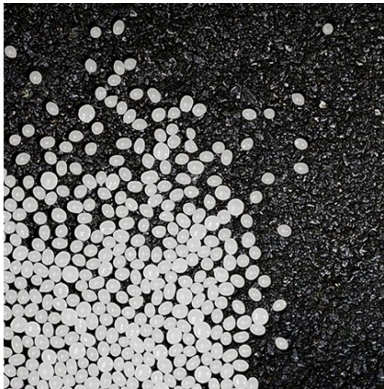
Obrázek 2 – Tvrdý syntetický vosk Sasobit [1]
