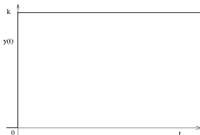
Obr. 29 Přechodová charakteristika soustavy 0. řádu
