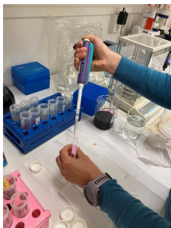
Bilde 3. Jord blandes med en kjent konsentrasjon av permanganatløsning, ristes kraftig på en maskin og væske fra dette tynnes ut og has i små gjennomsiktige rør (vb). Jo mer farge som er igjen, desto mindre aktivt karbon er det i prøven (mb). Prøvene leses av i en maskin (hb), for så å omregnes til mengde aktivt karbon pr gram tørr jord (Foto R. Pommeresche).
