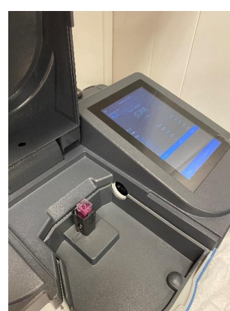
Bilde 3. Jord blandes med en kjent konsentrasjon av permanganatløsning, ristes kraftig på en maskin og væske fra dette tynnes ut og has i små gjennomsiktige rør (vb). Jo mer farge som er igjen, desto mindre aktivt karbon er det i prøven (mb). Prøvene leses av i en maskin (hb), for så å omregnes til mengde aktivt karbon pr gram tørr jord (Foto R. Pommeresche).
