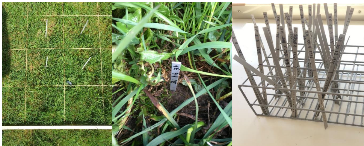
Bilde 7. Matpinner er plastpinner med 16 hull som er fylt med OM (hb). Pinner med alle huller fylt med OM settes i jorda (vb og mb). Etter en viss tid tas matpinnene opp og da er noen hull spist tomme, noen er halvfulle og noen er helt fylt og urørt av jordlivet (hb) (Foto Reidun Pommeresche).
