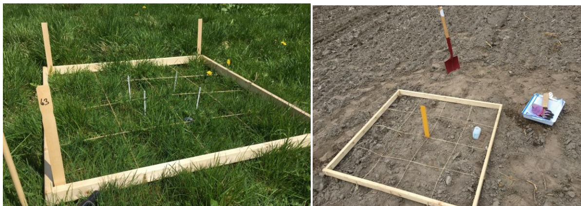
Bilde 2. En treramme 1 m 2 med trådruter ble brukt i felt for å samle inn jordhelsedata og for å finne igjen matpinner (grå plastpinner) som ble stukket ned i jorda i midten av rammen. Venstre bilde (vb) er fra beite ved Tingvoll gard den 19.5. 2021, da matpinner ble satt ut. Høyre bilde (hb) er fra måling av jordrespirasjon i Potetfeltet 6.7.2021. Foto Reidun Pommeresche.
