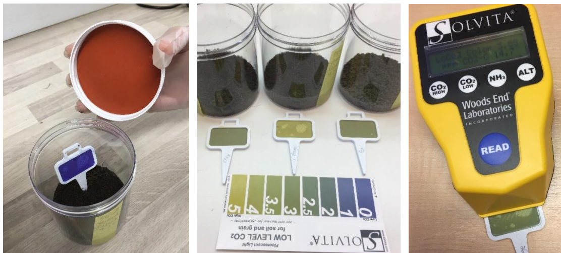
Bilde 8. I Solvita respirasjonstest has siktet jord i et beger og et plastsilt med en blå geleplate settes i begeret som så får tett lokk på (vb). Geleen på platene skifter til ulike farger som gjengir mengde produsert CO 2 (mb). Fargen kan leses av via et fargekart (nederst mb) eller ved å sette skiltet i et måleapparat (hb) (Foto R. Pommeresche).
