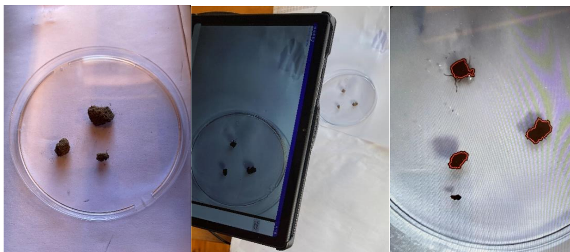
Bilde 10. Lufttørka jordklumper (4-8 mm) ble brukt i stabilitets/erosjonstesten (Slakes) (vb). I en app tas det bilde av tørre aggregater, så has det vann rundt og det tas en serie med bilder i løpet av 10 minutter (mb). På skjermen i appen ser man en rød kant rundt aggregatene (hb), dette er med å «beregne» endring i aggregatenes form utover i målingen. Det måtte være en viss størrelse på aggregatene for at denne røde arealkanten skulle bli stabil og for at målingen skulle kunne kjøres (Foto R. Pommeresche).
