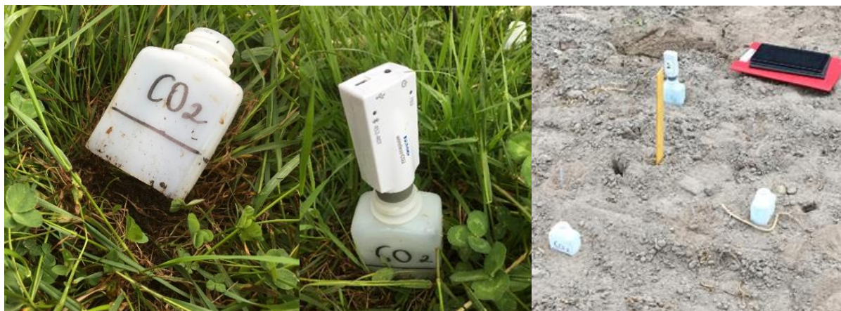
Bilde 9. Til respirasjonsmålinger i felt ble plastflasker uten bunn (vb) presset litt ned i bakken, slik at det ble lufttett rundt kanten. Sensoren ble så satt i åpningen og målte i 3 minutter (mb). Prøveflasker i potetfeltet der flasken bak den gule pinnen har sensoren i som måler CO 2 (vb). (Foto R. Pommeresche).
