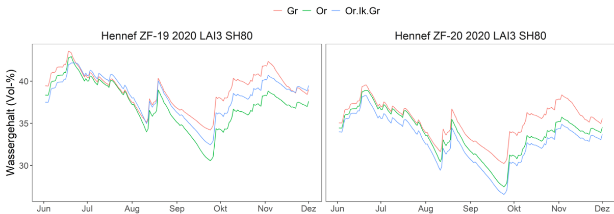
Abb. 93: Simulierte volumetrische Wassergehalte im Jahresverlauf für den Zwischenfruchtversuch am Standort Wiesengut; basierend auf Wetterdaten aus dem Jahr 2020 und den im Jahr 2019 bzw. 2020 bestimmten Wurzellängendichteverteilungen und hydraulischen Bodeneigenschaften, bei Annahme eines Blattflächenindex von 3 und einer Bestandeshöhe von 80 cm. Verglichen werden die Anbauvarianten mit dem konträrsten Verhalten hinsichtlich des volumetrischen Wassergehaltes.
