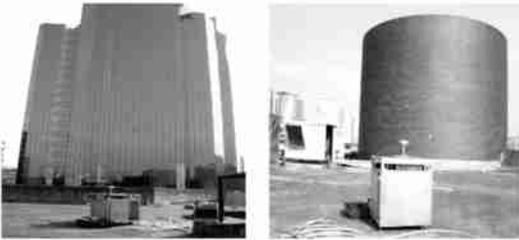
图 2 产生 GPS 多路径效应的周围环境及模拟振动台
