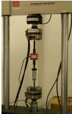
(a) EM damper tested on MTS machine
