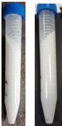
Figura 6: Pomada hidrófila com SLN incorporadas após o primeiro (à esquerda) e o segundo (à direita) ciclo de centrifugação.
