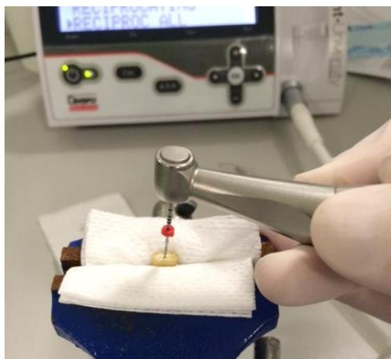
*Figura 7 - Preparação do SCR com Reciproc<sup>®</sup>*
