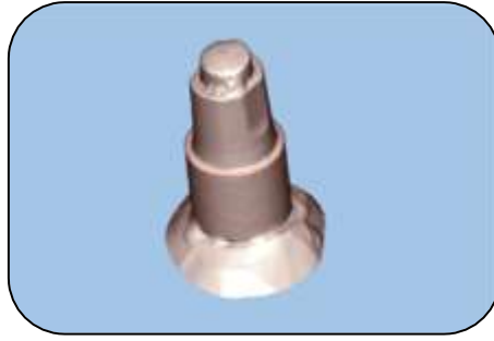
Fig. 6) Imagem de desenho assistido por computador obtida pela leitura de um pilar 4,1mm sobre o implante dentário analógico de 5,0mm (Bertolini et al. , 2014)
