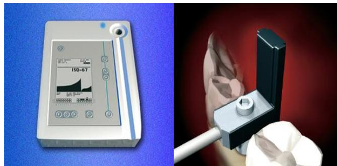
Ilustração 12: Unidade Osstell® (à esquerda) e transdutor em forma de L, atualmente substituído pelo *SmartPeg*™ (à direita).
