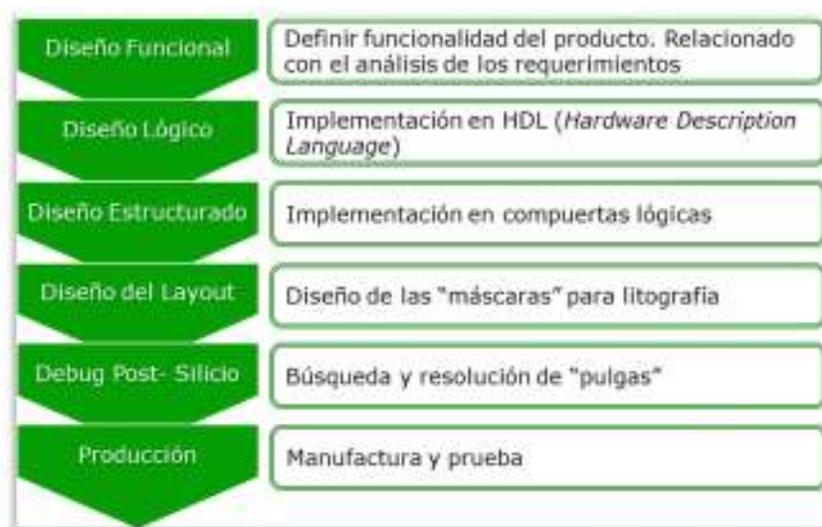
Figura 4: Proceso de diseño de circuitos integrados VLSI
