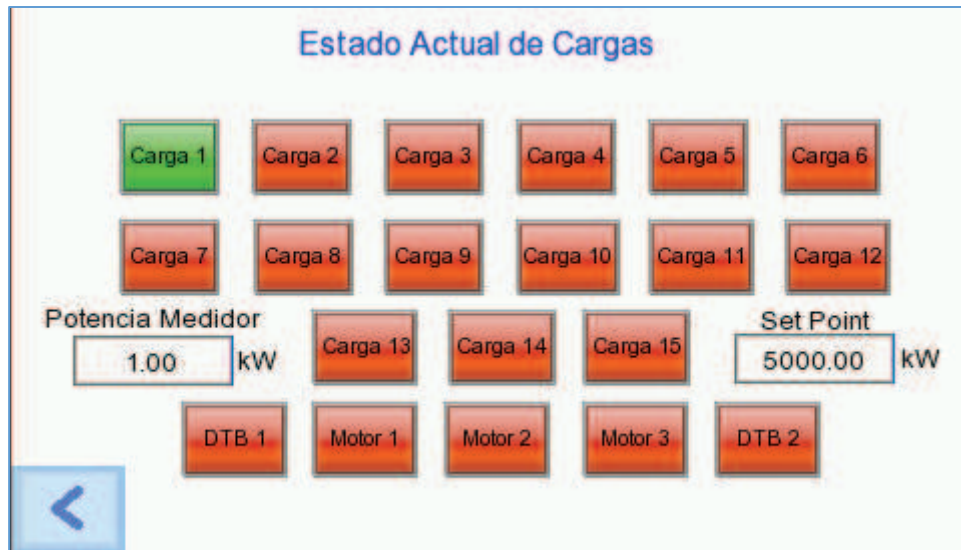
Figura 25. Ventana de supervisión estado actual de cargas
