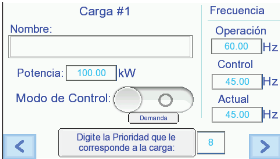
Figura 3.19. Ventana Configuración de variador de frecuencia (Fuente: Elaboración Propia)
