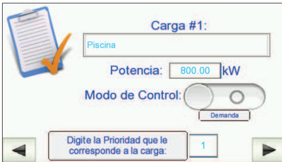
Figura 3.16. Ventana Configuración de carga discreta en modo de control demanda (Fuente: Elaboración Propia)
