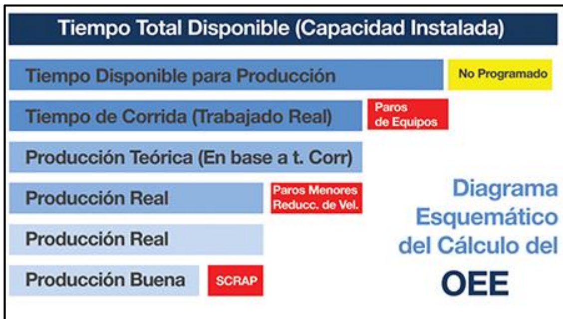
Figura 2.3. Diagrama esquemático del cálculo del OEE
