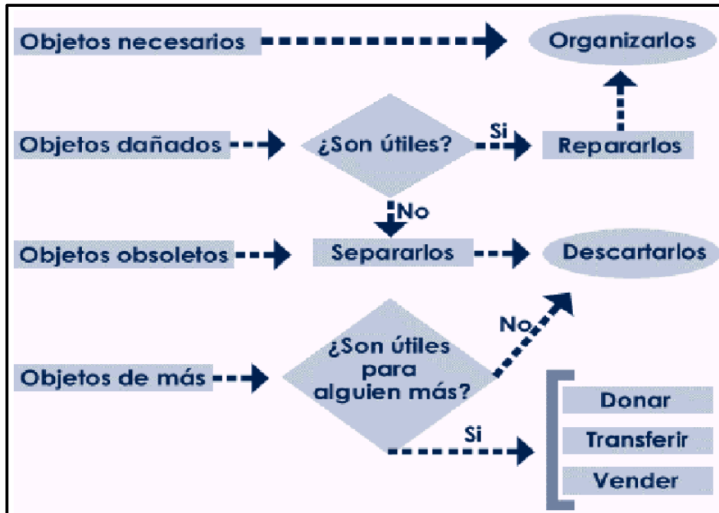
Vargas, H. (2004). Manual de implementación programa 5S Figura 2.2. Diagrama de flujo de clasificación 5S
