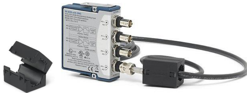
Figura 6.68 Ferritas de eliminación de ruido por interferencia electromagnética (EMI)
