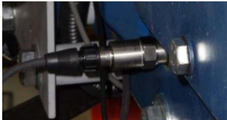
Figura A8.32 Colocación de acelerómetro para la caja multiplicadora, posición axial
