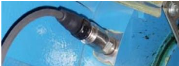
Figura A8.28 Colocación de acelerómetro para el rotor, posición axial
