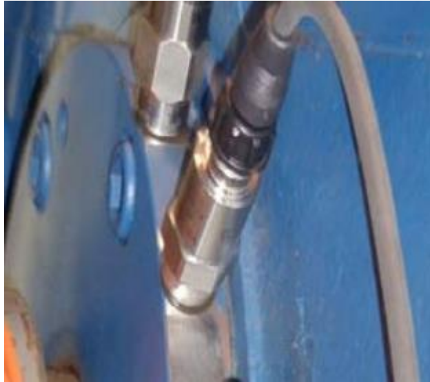
Figura A8.31 Colocación de acelerómetro para la caja multiplicadora, posición radial
