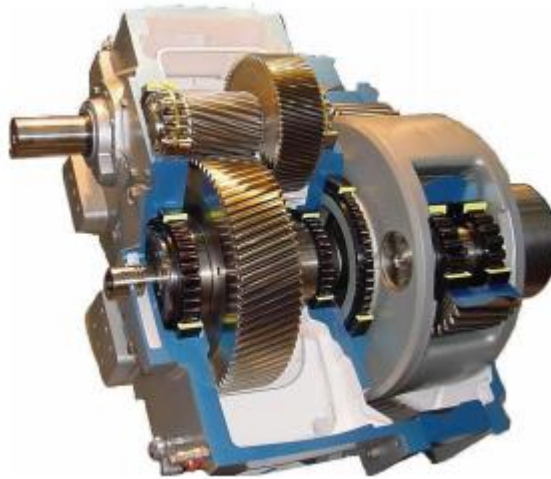
Figura 4.30 Caja multiplicadora de dos etapas
