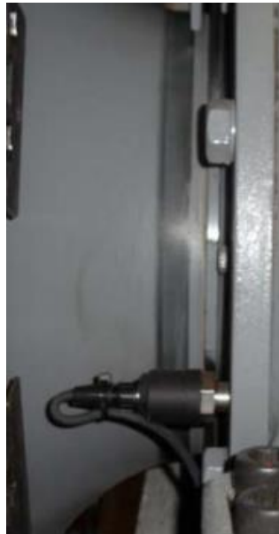
Figura A8.30 Colocación de acelerómetro para el rodamiento principal, posición axial
