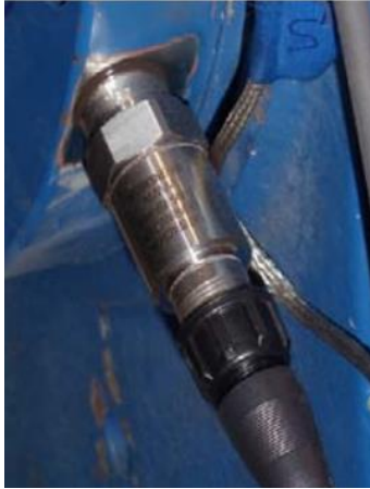
Figura A8.27 Colocación de acelerómetro para el rotor, posición radial
