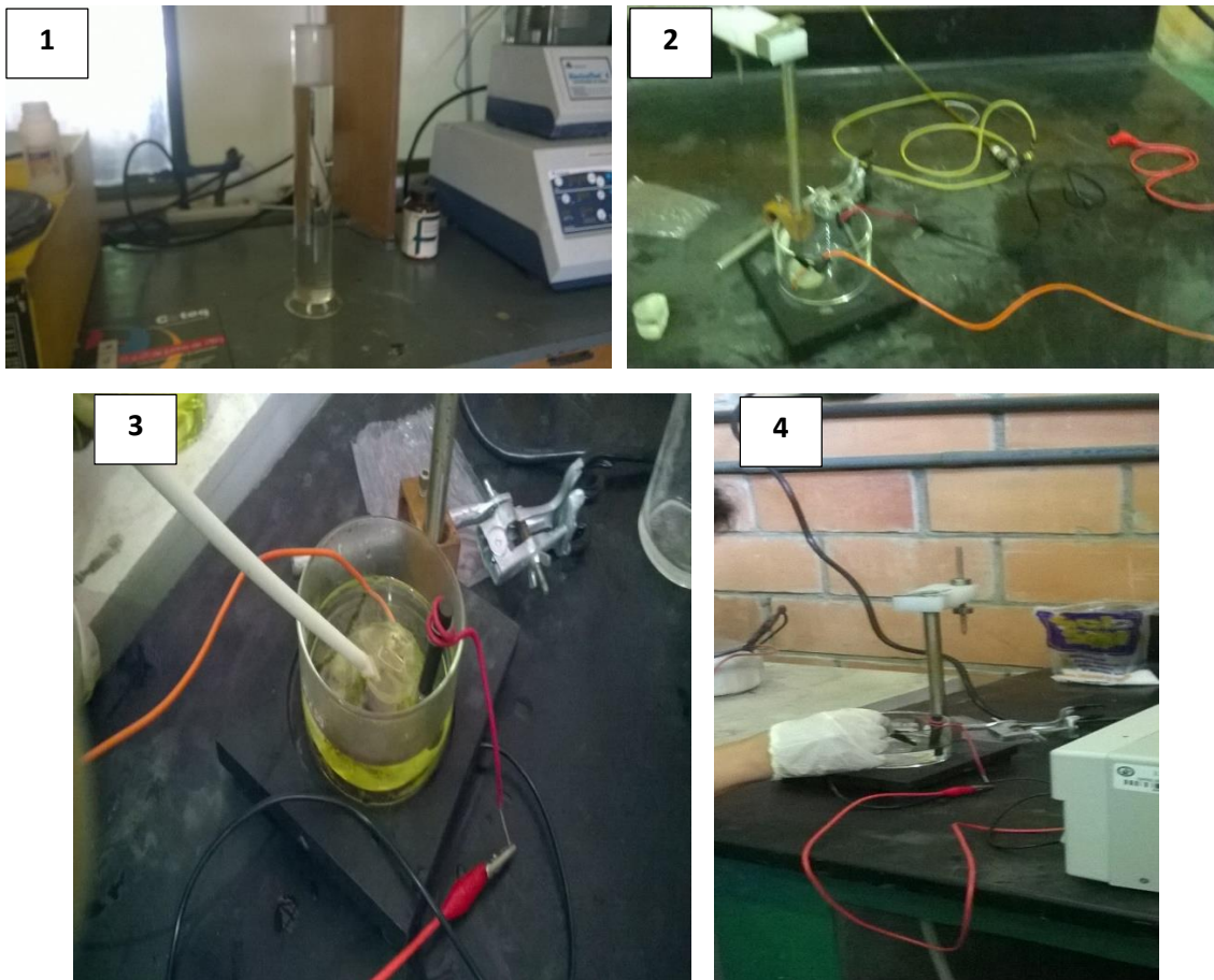
Figura 9. Etapas del montaje del equipo de electro-pulido. Las etapas son las siguientes: 1) mezcla de reactivos, 2) montaje de electrodos, 3) establecimiento de valores de corriente y voltaje, 4) pulido de las probetas.
