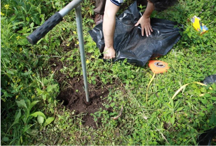
Figura 21: Uso de barreno para la toma de la muestra de los perfiles del suelo
