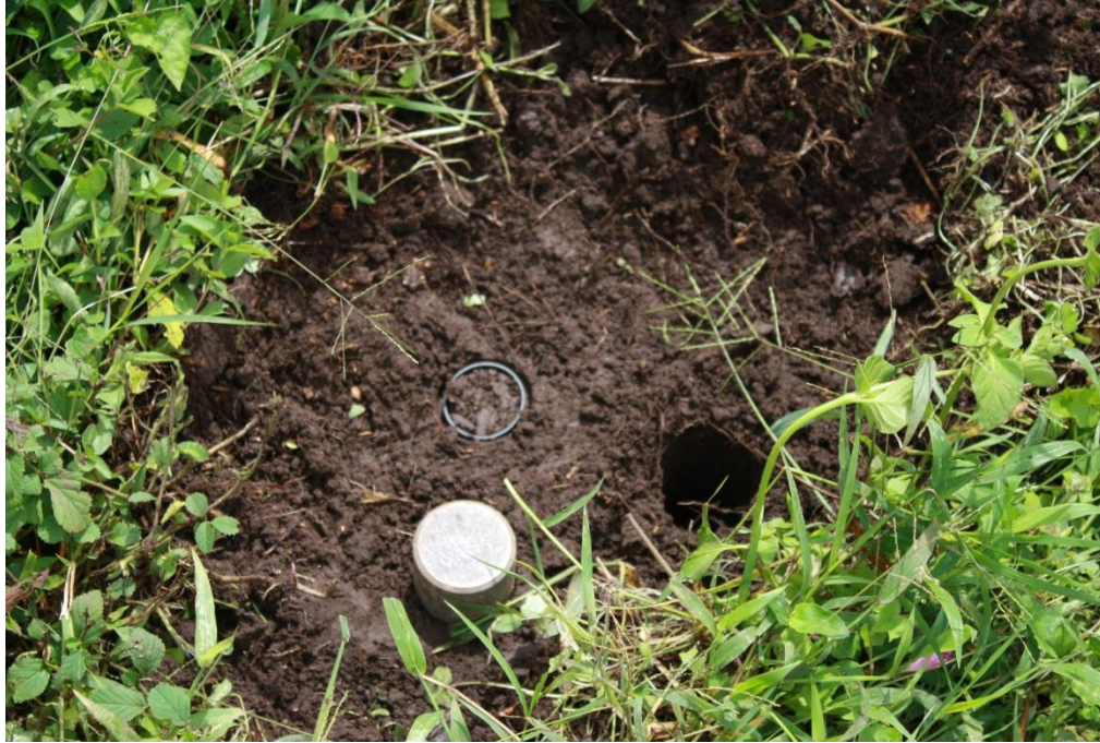
Figura 23: Toma de muestra de perfil no perturbado de suelo para análisis de textura y porosidad
