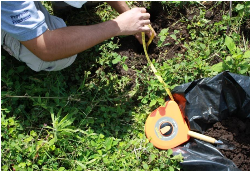
Figura 22: Medición de profundidad del perfil y toma de muestra de suelo
