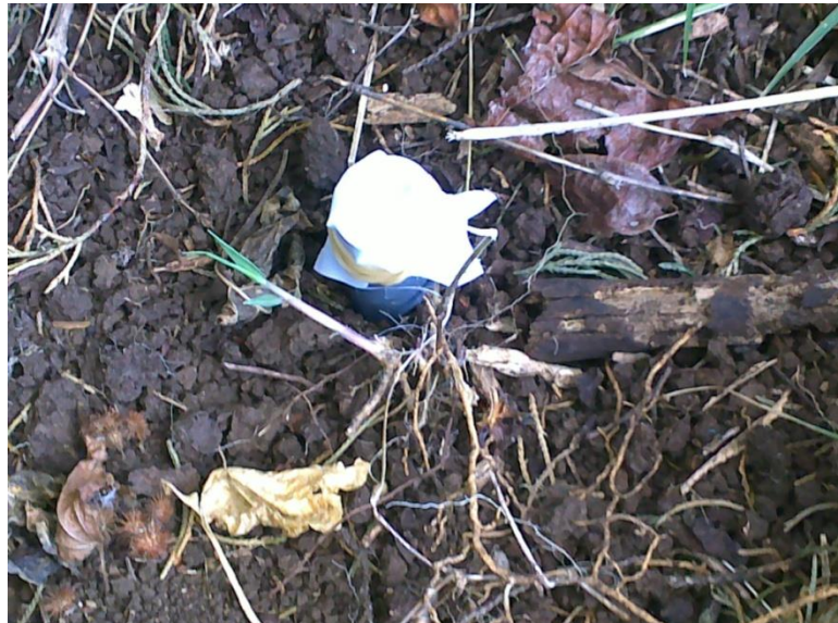
Figura 23: Dispositivo para la determinación de perfil de infiltración de los plaguicidas en campo.
