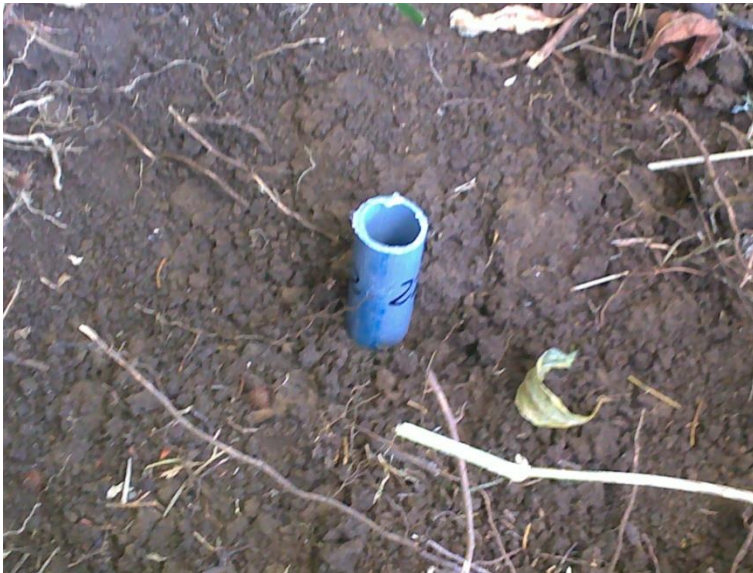
Figura 23: Dispositivo para la determinación de perfil de infiltración de los plaguicidas en campo.
