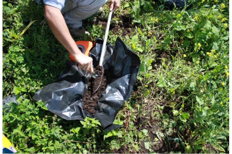
Figura 21: Uso de barreno para la toma de la muestra de los perfiles del suelo
