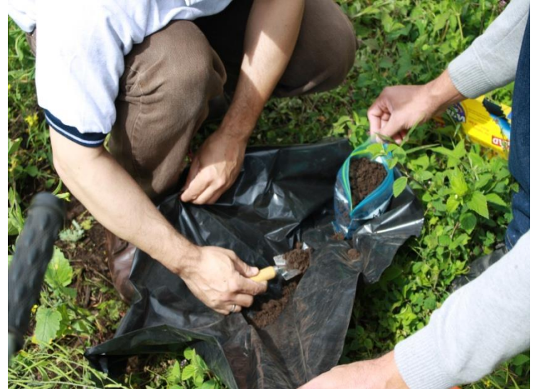
Figura 22: Medición de profundidad del perfil y toma de muestra de suelo
