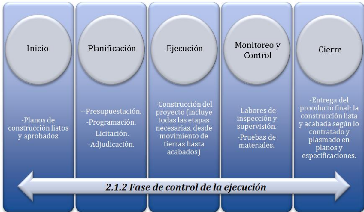
Figura 2.3. Fase de control de la ejecución.
