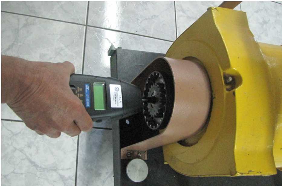
Figura N° 8. Medición de rpm con un tacómetro digital. Canon. Investigadores.
