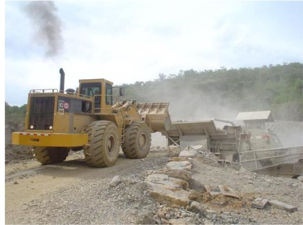
**Figura 6.** Cargador alimentando tolva del impactor.
