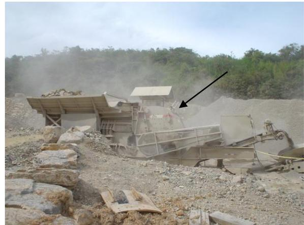
**Figura 7.** Impactor en proceso de trituración de la piedra.
