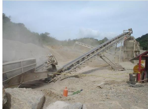
**Figura 10.** Salida del impactor al conveyer 1.
