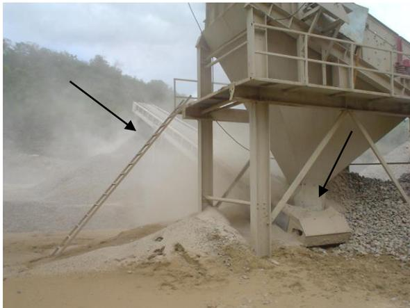
**Figura 12.** Salida del material final de la criba al conveyer 2.
