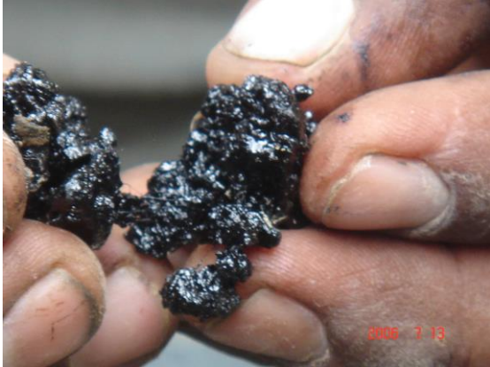
Figura 7. Muestra de la mezcla asfáltica con látex UP70SBR.
