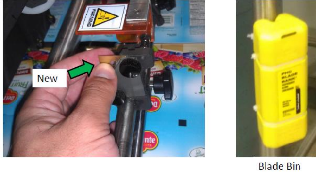
Figura 2.19. Instrucciones dadas para el cambio de cuchillas.
