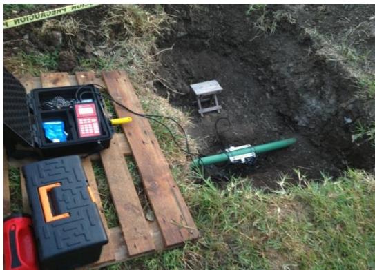
Imagen 9. Grabación de mediciones de caudal.
