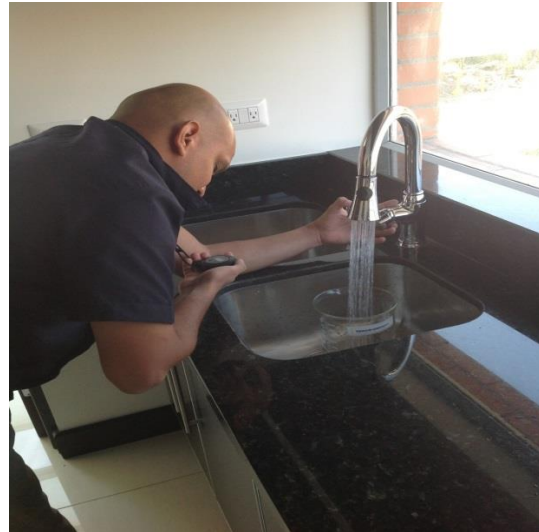
Imagen 3. Aforo del fregadero del edificio de apartamentos.
