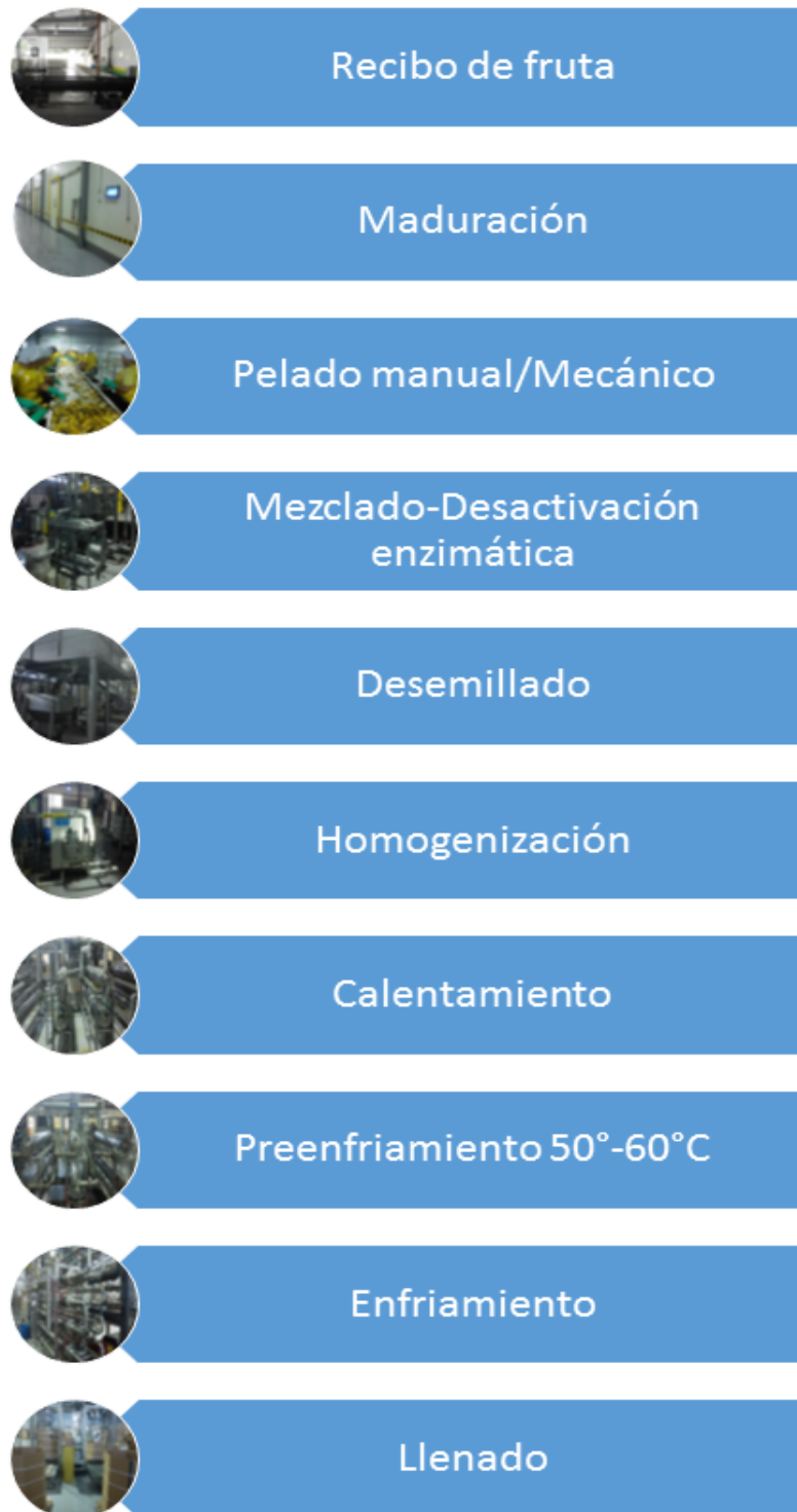
Figura 8.2-8. Diagrama de flujo del proceso de puré de banana. Fuente: Frutilight S. A. Diseño: propio.
