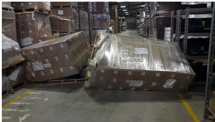
Figura 8.5-2. Consecuencia de la falta de espacio y ausencia de un programa de 5 S en la bodega de insumos. Fuente: Bodega de insumos Frutilight.
