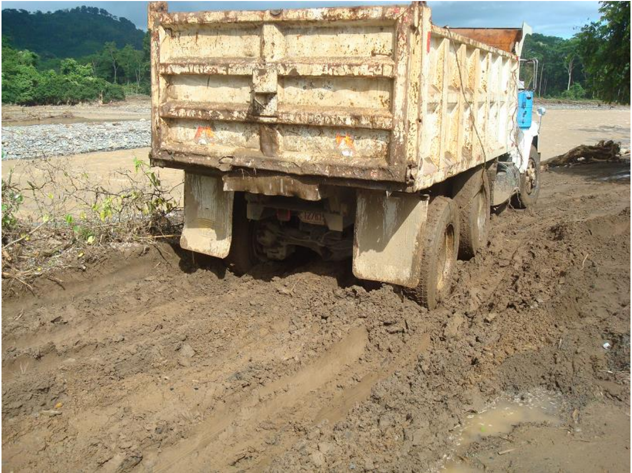
Fotografía de las condiciones de las rutas de acceso a fuentes de extracción, después de unas horas de uso.
