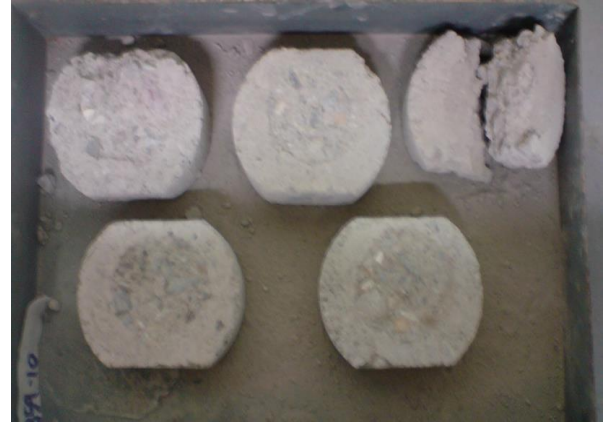
Figura 13. Probetas con 6% de cemento, falladas a los 7 días bajo la norma ASTM C 944-99.
