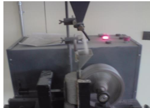
Figura 9: Falla de probeta de abrasión. Máquina colombiana para abrasión de adoquines.
