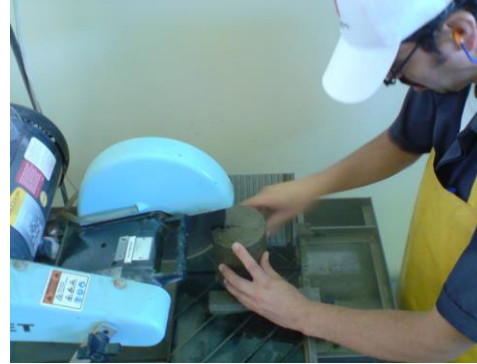
Figura 8: Aserrado de la probeta de abrasión para la máquina colombiana para abrasión de adoquines.
