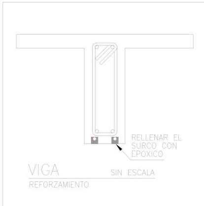
Figura 24. Relleno de surcos. Autocad 2005.
