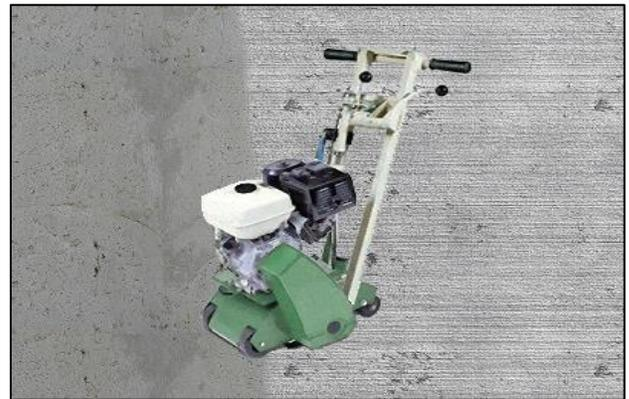
**Figura 79.** Fresado de la superficie del concreto.
