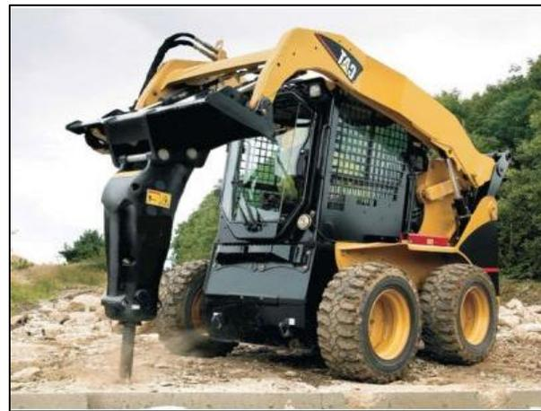
**Figura 71.** Martillo hidráulico para la remoción de losas en pavimentos de concreto.
