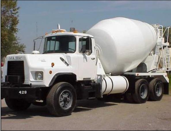
Figura 72. Camión mezclador o “chompipa”.
