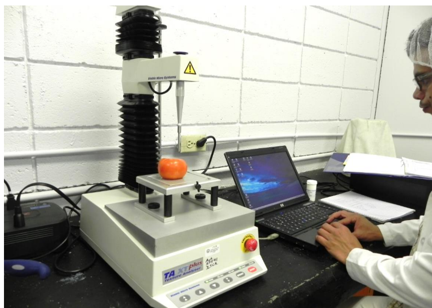
Figura 26. Toma de datos de firmeza a partir de texturómetro TA XT Plus
