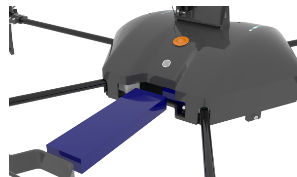
Imagen41. Removiendo la batería
