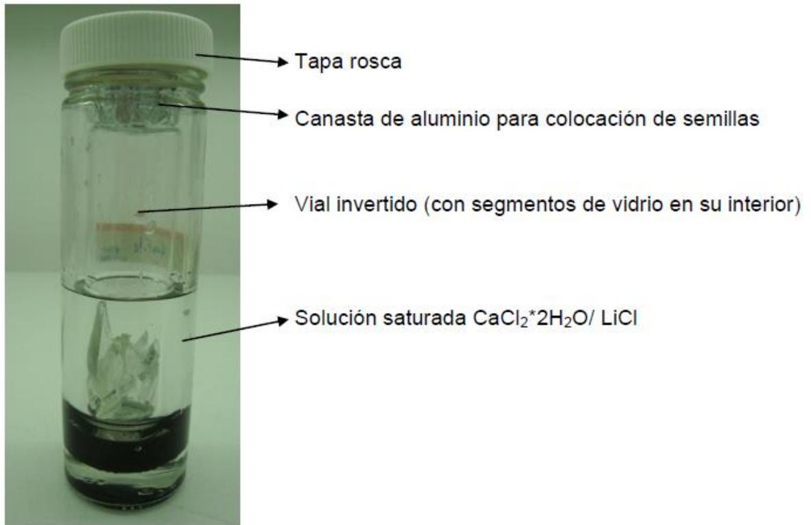
**Figura 3.** Sistema de deshidratación con tapa rosca, utilizado para deshidratación por medio de soluciones saturadas de  $\text{CaCl}_2 \cdot 2\text{H}_2\text{O}$  y  $\text{LiCl}$ .
