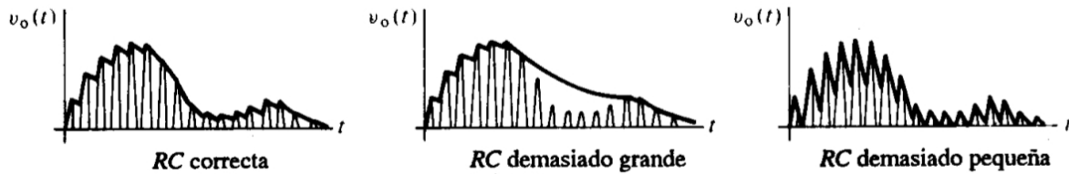
Figura 2.2: Proceso de demodulación con detector de envolvente. Tomada de [43].
