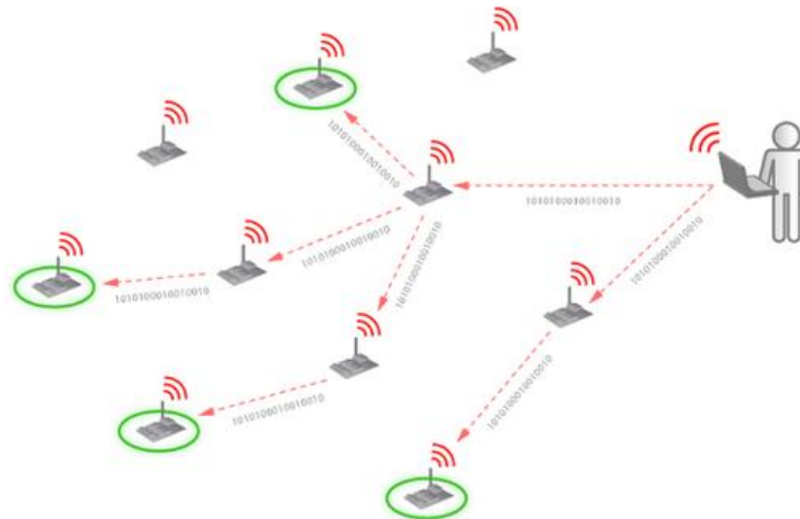
Figura 4.1. Figura demostrativa de la metodología de programación OTA para los nodos Wasmote [6]
