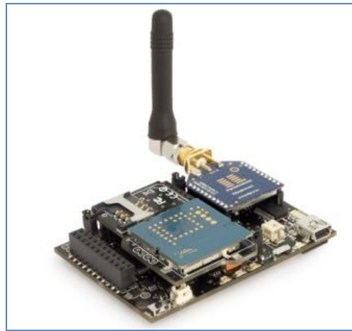
Figura 3.2. Sistema embebido Wasmote de Libelium [6]
